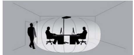
Fig. 11: Erfassungsbereich HFMD Sensor.
