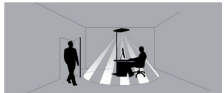
Fig. 12: Erfassungsbereich PIR Sensor.
